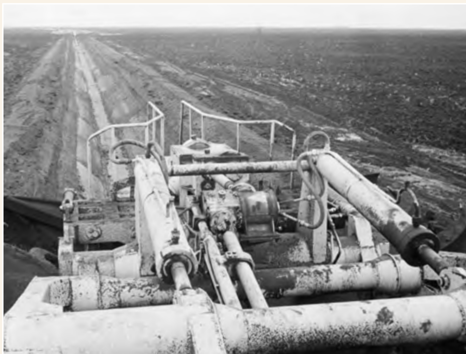
На основе трактора Т-180 были спроектированы самые крупные в стране роторные экскаваторы.
