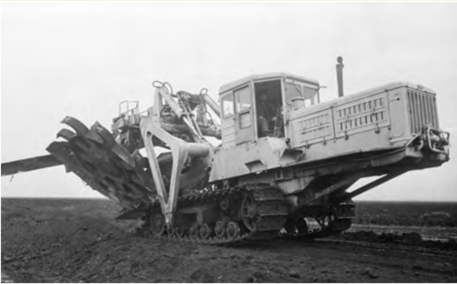
Роторный экскаватор ЭТР-122, созданный на базе Т-180Г, во время прокладки канала. Куйбышевская область. 1967 г.
