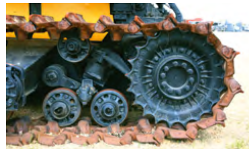
Ходовая часть Т-180 обеспечивала хорошее сцепление с грунтом и повышенную проходимость.
